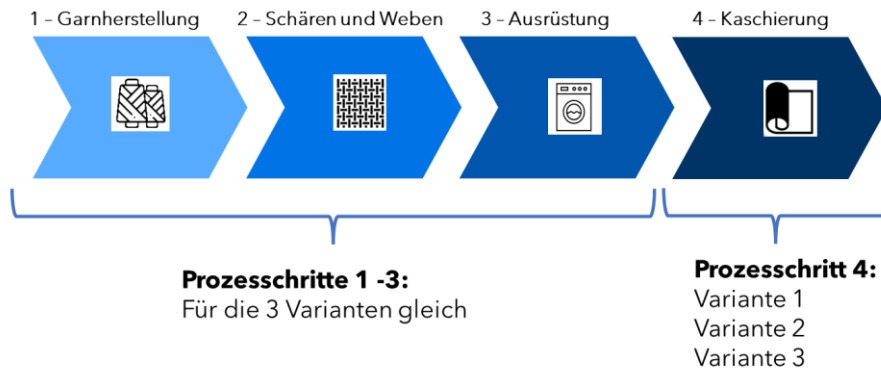
Abbildung 10: Produktschritte zur Herstellung eines Autositzbezuges innerhalb der Systemgrenzen
