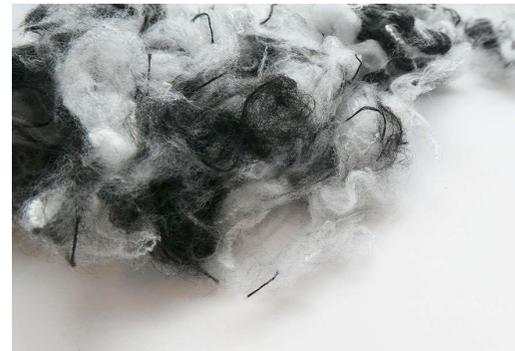
Durch die gezielte Sammlung von Produktionsabfällen und deren rein mechanischen Aufbereitung gelingt es uns in dieser Kollektion, wertvolle Sekundärrohstoffe zu nutzen, die in einer regionalen Kooperation zu hochwertigen Garnen verarbeitet werden. Daraus entwickeln und fertigen wir Gewebe, die höchsten
