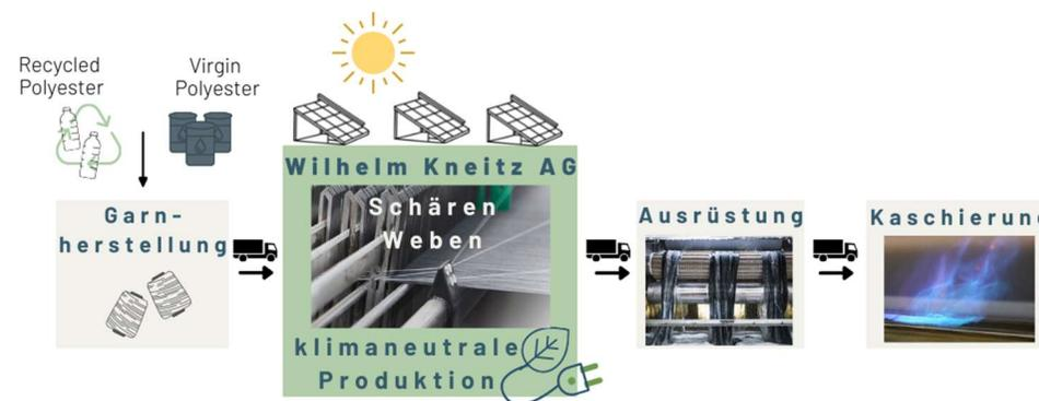
Abbildung 18: Prozessschritte vom Rohstoff zum Textil
