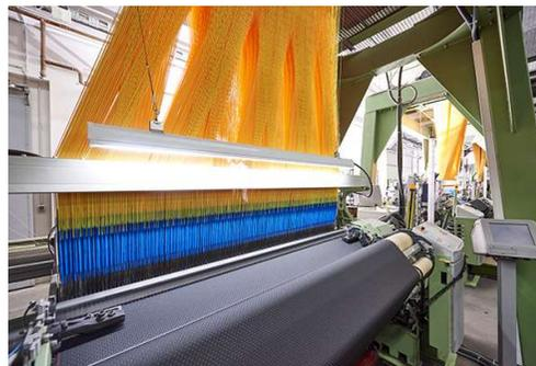
Dank der Digitalisierung und der Vernetzung aller unserer Produktionseinheiten stehen unsere Designs innerhalb kürzester Zeit für die Produktion zur Verfügung. Dort arbeiten unsere Hochgeschwindigkeits-Webmaschinen mit einer Geschwindigkeit von bis zu 1.000 Schusseinträge pro Minute bei höchster Präzision und Qualität.
