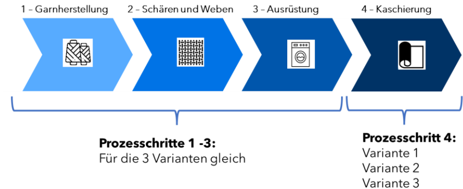
Abbildung 19: Produktschritte zur Herstellung eines Autositzbezuges innerhalb der Systemgrenzen
